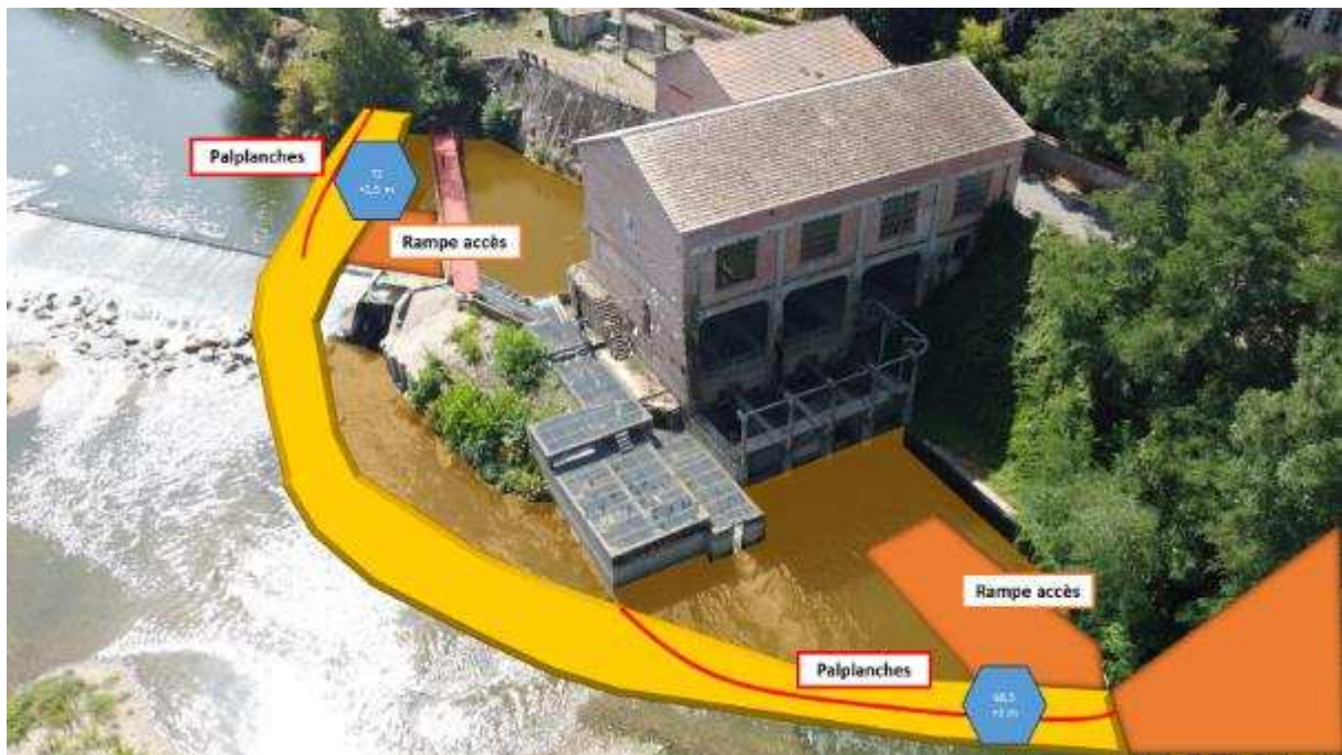
Figure 13 – Enceinte batardée autour de l'usine
